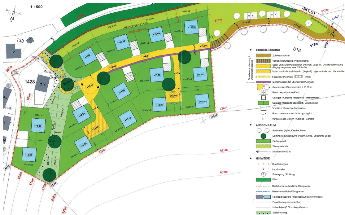
Abb. 5 Entwurf Überbauungsplan von 2011: In hellgrün die Steilböschung, in braun die geplante Erschliessung von Norden her (Quelle: Atelier Schneider Partner AG)
